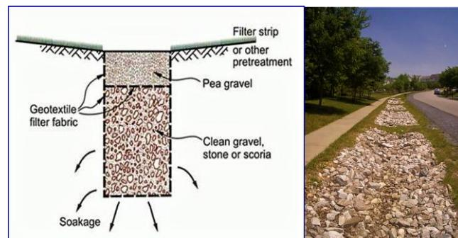
Infiltration through sand and gravel – appropriate for medium permeable areas, removes smaller substances and some dissolved pollutants. It is applicable for urban areas, appropriate for water inflows from the roof tops for areas smaller than 2 ha / **infiltracija kroz pjesak i šljunak – pogodno za područja sa umerenom propustljivošću, uklanja sitnije čestice i neke rastvorene zagađivače. Primjenjuje se u gradskim sredinama , pogodno i za prijem voda sa krovova za površine manje od 2 ha .**
