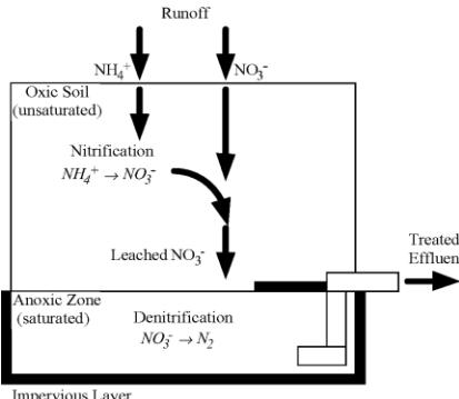
Diagram of Modified Bioretention for Denitrification / Šema modifikovane biodegradacije za proces denitrifikacije azota
